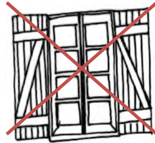
volets à écharpe dit « Z »
