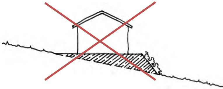
la mise à niveau par talutage
